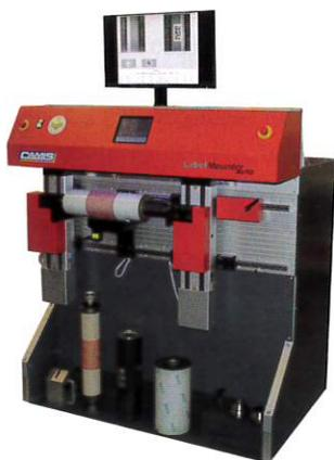
Das neue vollautomatische Plattenmontagegerät LabelMounter Auto LMA von Camis für den Etikettendruck
