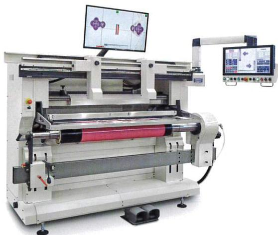
Das neue Plattenmontagegerät von Bieffebi Automa 373 bei dem praktisch alle Arbeitsschritte automatisiert sind.
